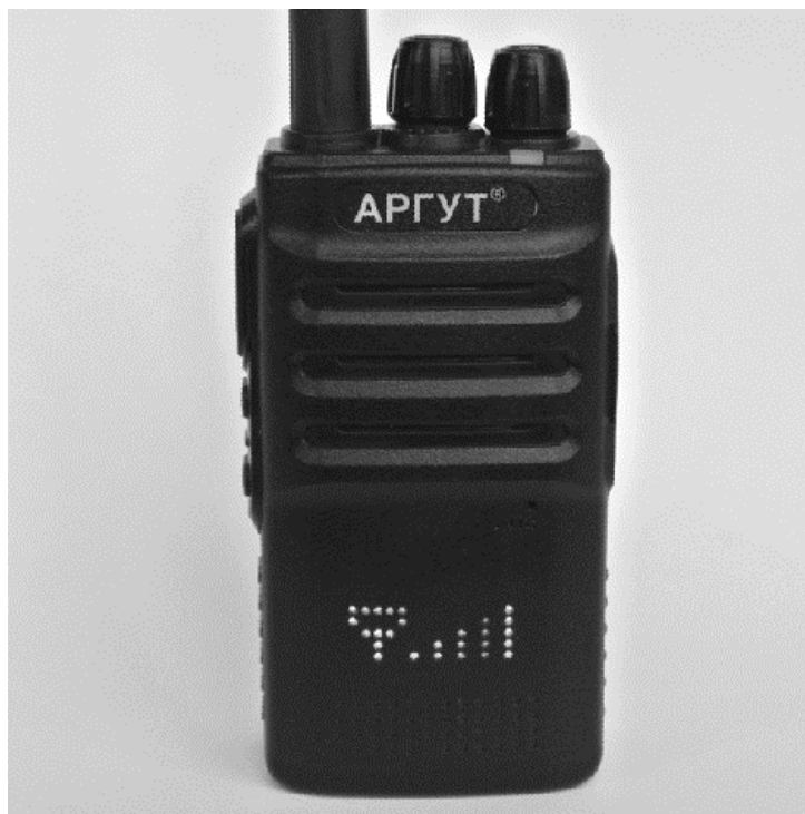
Рис. 12. Индикация уровня сигнала.
