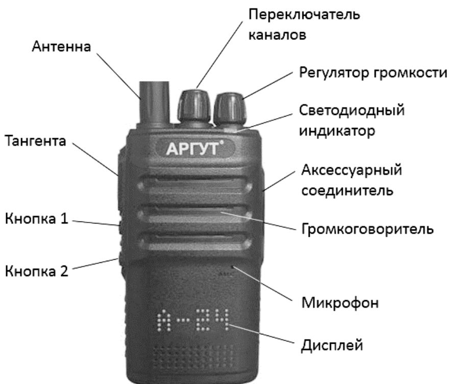
Рис. 1. Расположение органов управления, индикации и соединителей.
