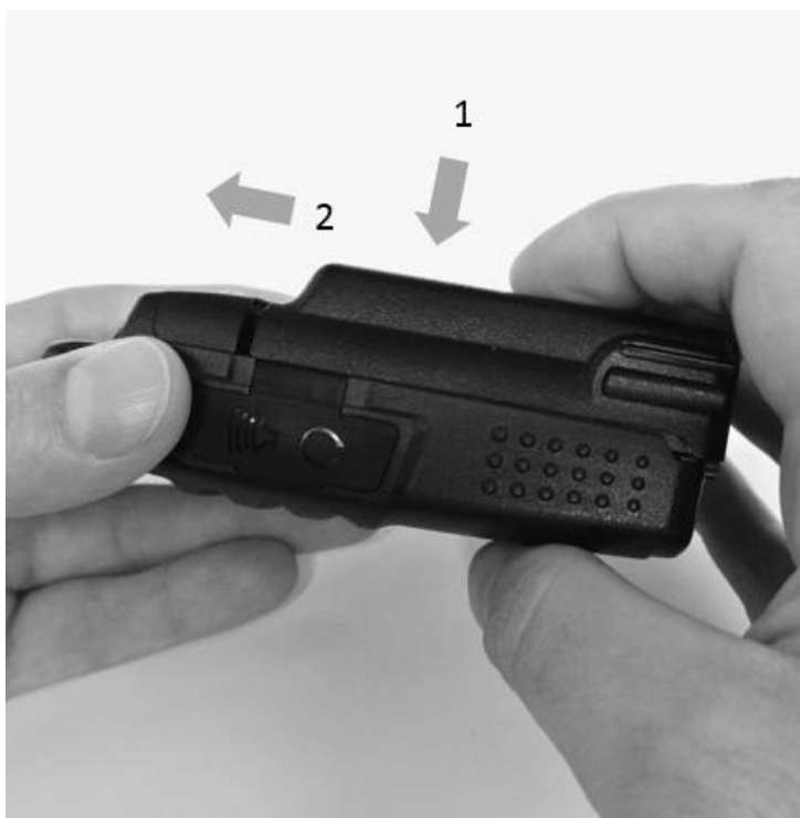
Рис. 2. Установка аккумуляторной батареи.
