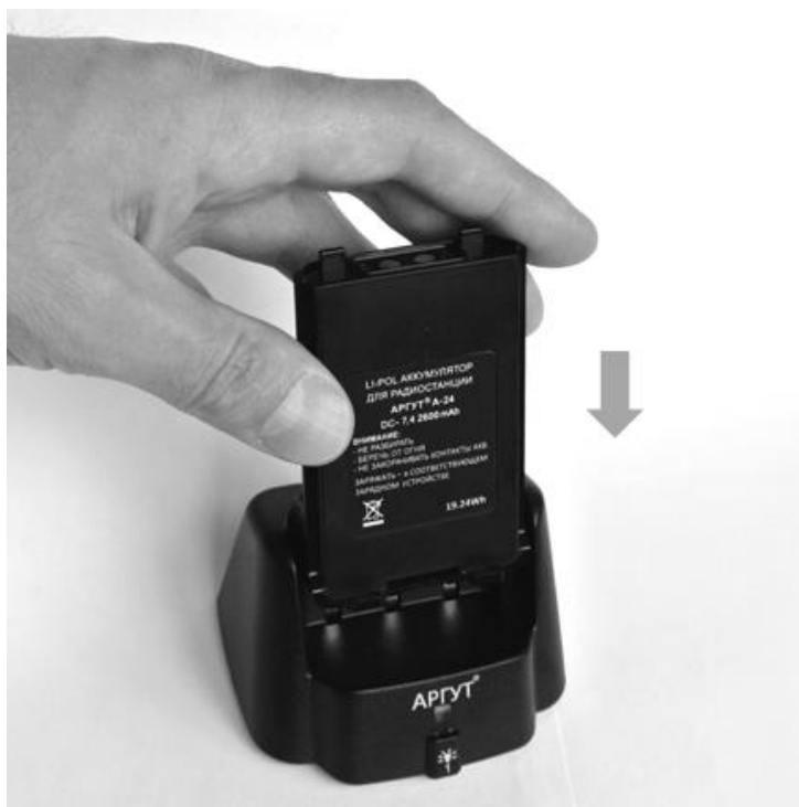
Рис. 7. Установка аккумуляторной батареи на зарядную базу.
